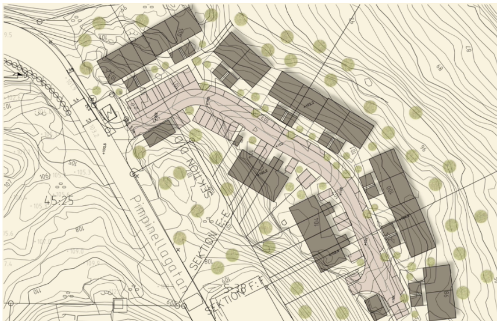
Bild 2: Situationsplan för projektområde A. Söder om tillfartsvägen planeras sju radhusenheter, väster och norr om vägen 32 bostadsenheter i sammanbyggda tvåbostadshus.
